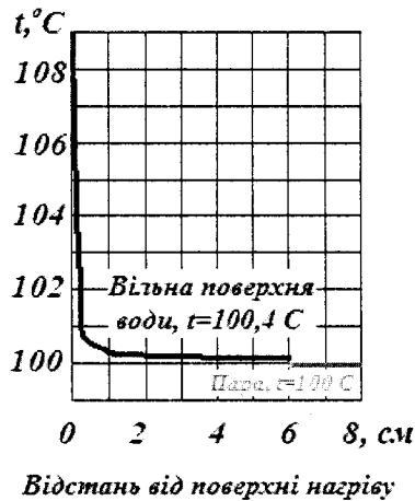
Рис. 4.6. Зміна температури по товщі шару води, яка кипить у великому об'ємі за p = 1 атм.
