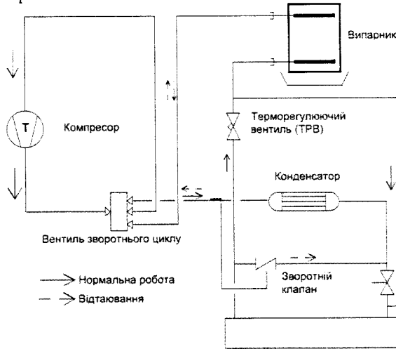
Рис. 8.73. Принципова схема відтавання ХУ, що має один випарник та конденсатор з повітряним охолодженням, гарячими газами за допомогою вентиля оборотності циклу (ХУ працює на аміаку)
