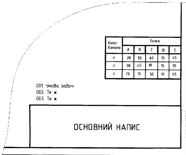
Рис. 4. Приклад розташування умови задачі й таблиці координат заданих точок на кресленні
