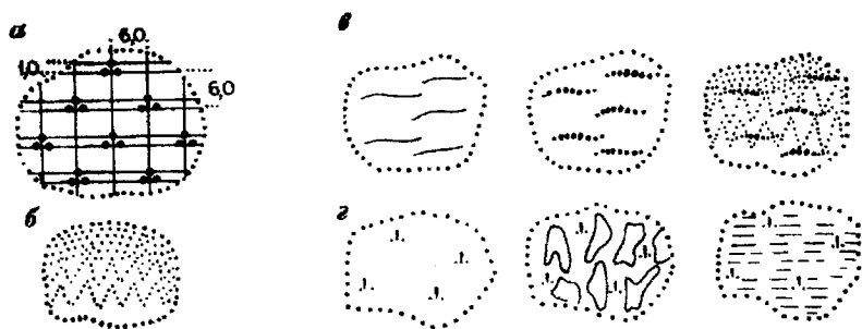
Рис. 3.41. Побудова і накреслювання деяких умовних знаків ґрунтів
