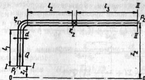
Рис. 6.1. Расчетная схема для определения потерь напора в простом трубопроводе
