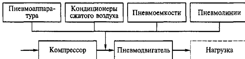
Рис. 16.1. Структурная схема пневмопривода
