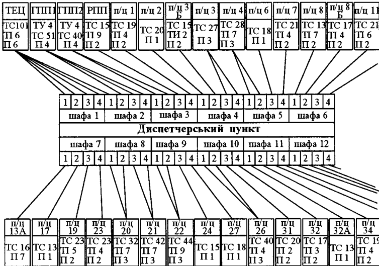
Рисунок 7.7 – Система керування електропостачанням крупного підприємства
