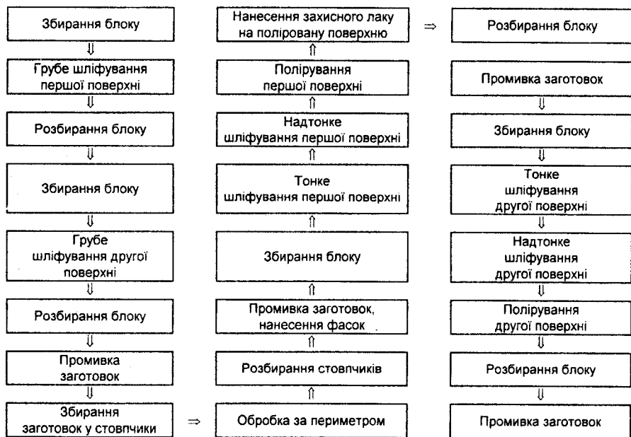
Рис. 7.1. Схема технологічного процесу виготовлення плоскопаралельних пластин
