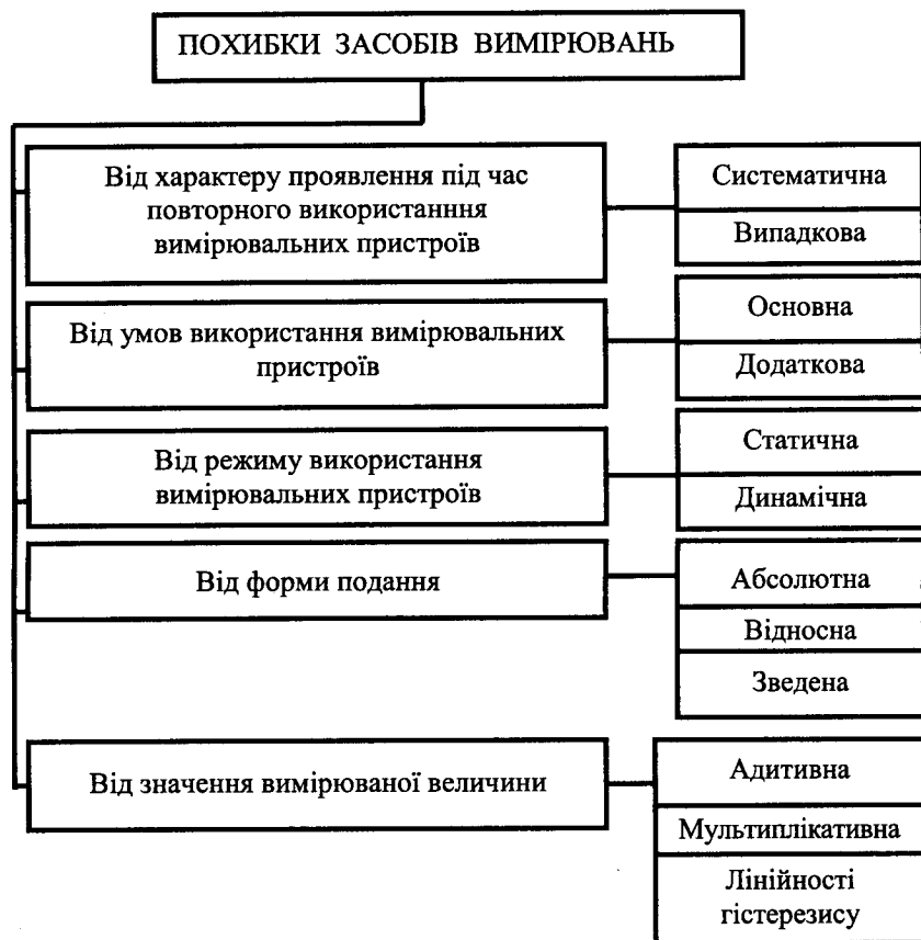
Рис. 1.6. Класифікація похибок засобів вимірювань
