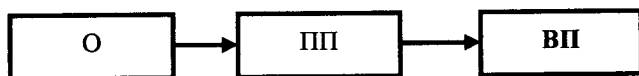
Рис. 1.7. Структурна схема вимірювання неелектричних величин: О – об'єкт вимірювання; ПП – первинний перетворювач; ВП – вторинний прилад
