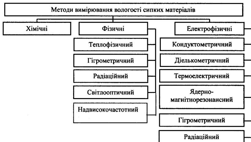
Рис. 7.1. Структурна схема класифікації методів для вимірювання вологості сипких матеріалів
