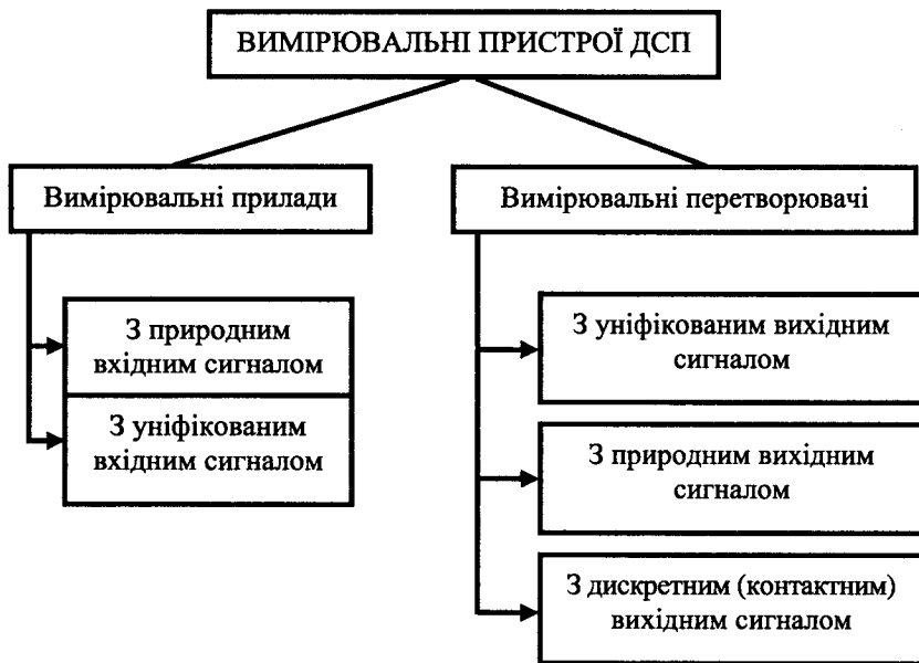
Рис. 1.46. Структурна схема організації вимірювальних пристроїв ДСП
