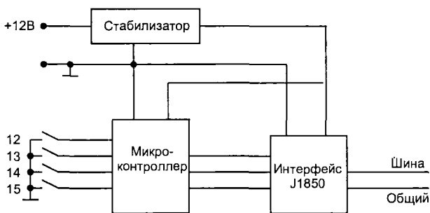
Рис. 6.16. Подключение устройств двери
