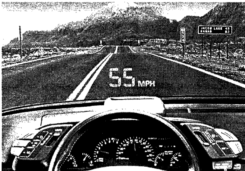
Рис. 5.13. Вид через ветровое стекло автомобиля с HUD
