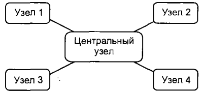
Рис. 6.10. Сеть звездообразной топологии
