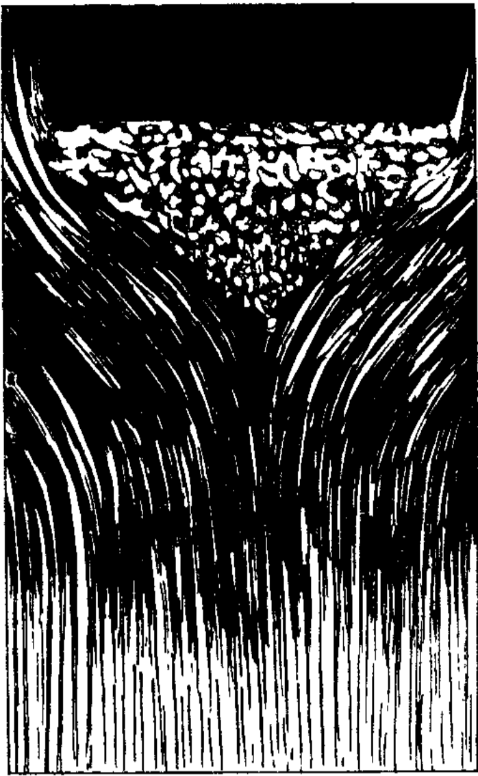
Рис. 4.2. Форма жесткого ядра в сыпучем материале при вдавливании штампа (по опытам Биареза)
