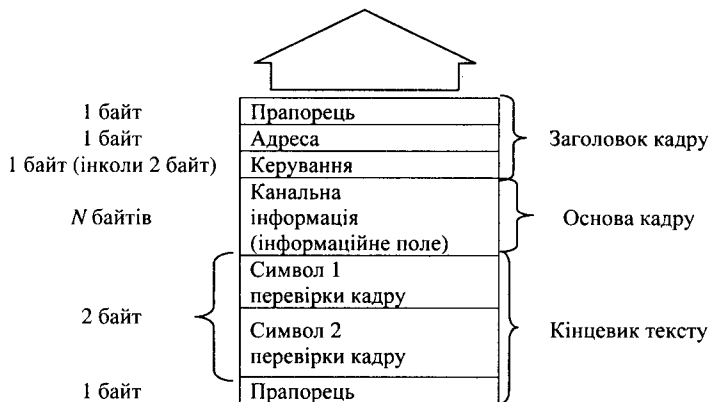
Рис. 13.18. Формат (структура) кадру HDLC
