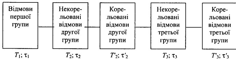
Рис. 15.13. Еквівалентна схема для розрахунку надійності каналу зв'язку
