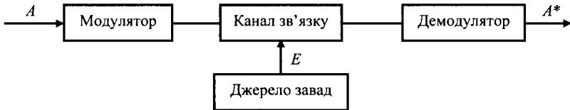
Рис. 11.1. Спрощений варіант СПДІ, що пояснює загальний процес передавання даних
