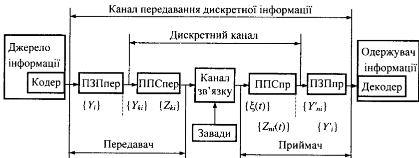
Рис. 7.4. Структурна схема системи передавання дискретної інформації
