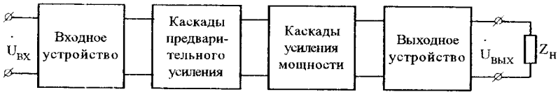
Рисунок 1.6 — Структурна схема усилителя
