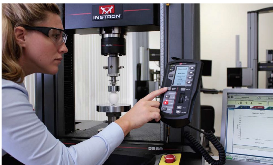
Рис. 7.20. Випробування делікатних зразків на машині Instron 5969 (www.instron.com)
