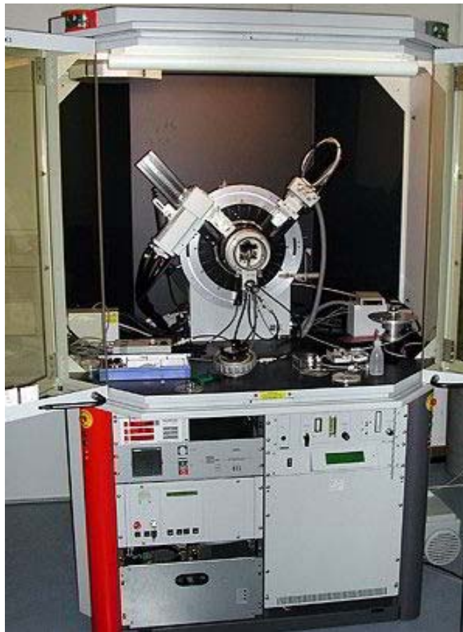
Рис. 7.7. Фотографія рентгенівського дифрактометра D8 Advance (Bruker-AXS, Germany, www.bruker-axs.de )
