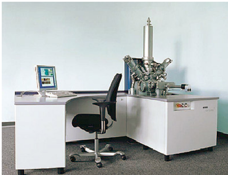
Рис. 7.9. Фотографія установки для аналізу за методом вторинно-іонної мас-спектроскопії TOF.SIMS-5 (VG Ionex, Великобританія)
