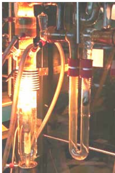
Рис. 6.23. Установка для синтезу фулеренів та вуглецевих нанотрубок з використанням індукційного нагрівання
