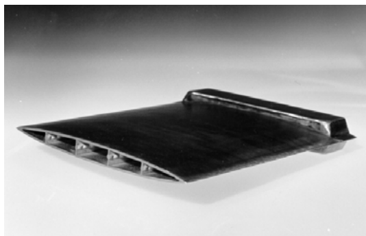
Рис. 8.2. Модель пустотілої лопатки газотурбінного двигуна, виготовленої за інтегральною технологією зварювання тиском із надпластичної формовки зі сплаву ВТ6 при температурі, що не перевищує T = 800\text{ }^{\circ}\text{C} [1]
