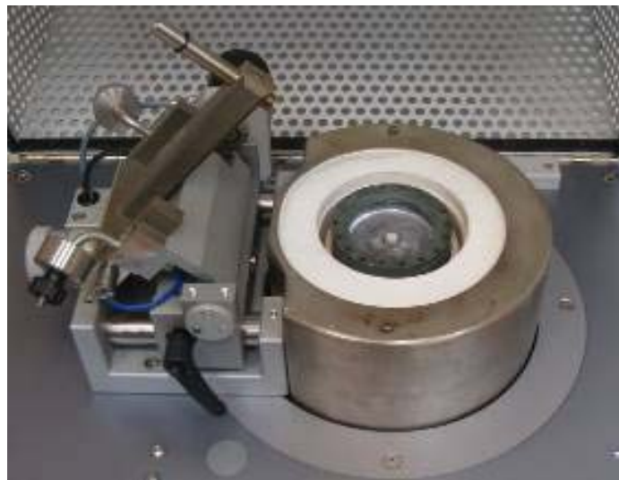
Рис. 7.28. Загальний вигляд високотемпературного вузла машини тертя High Temperature Tribometer, CSM Instruments, Швейцарія
