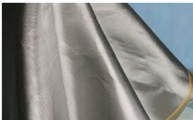
Рис. 8.24. Зображення плівки аморфного гідрогенізованого вуглецю з ферромагнітними наночастинками на гнучкій підкладці
