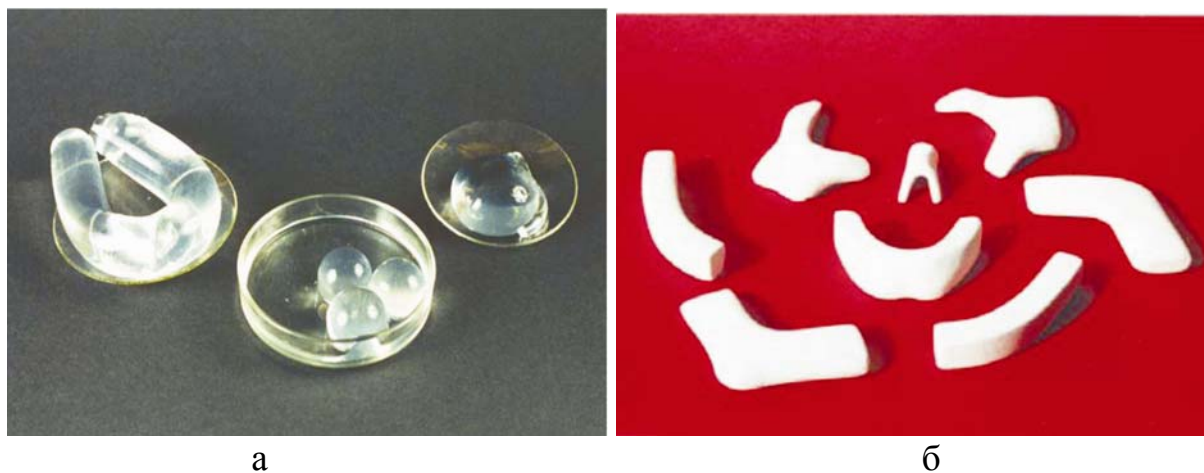
Рис. 8.11. Нові полімерні матеріали для офтальмології а) та імплантати для кісткового ендопротезування на основі скла, ситалів і кераміки б)
