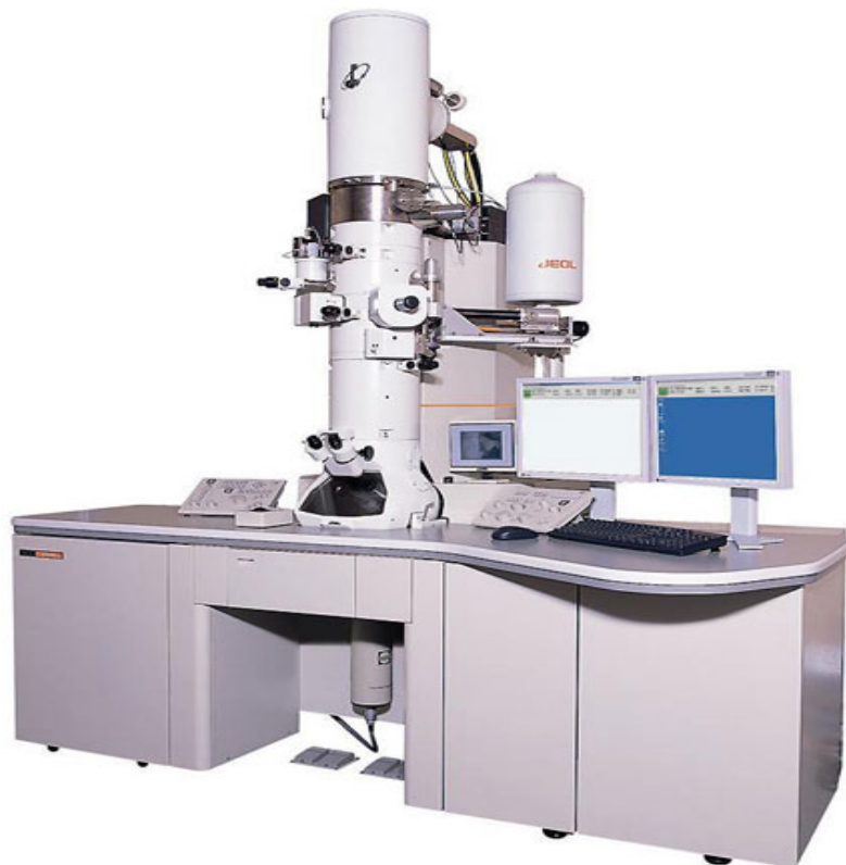
Рис. 7.1. Фотографія просвічуючого електронного мікроскопа з термопольовою емісією JEM - 2100F (виробник JOEL Ltd, Японія)
