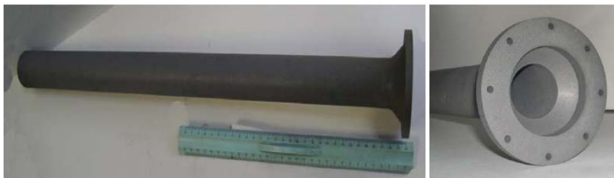
Рис. 8.4. Довгомірна деталь із пористого наноберилію. Довжина трубчастої частини – 600 мм, діаметр – 40 мм, щільність – 0,27 \text{ г/см}^3 . Діаметр фланця – 108 мм, товщина – 8 мм, щільність – 0,40 \text{ г/см}^3 . Міцність при стисненні матеріалу: в трубчастій частині – 24 МПа, у підфланцевій частині – 45 МПа
