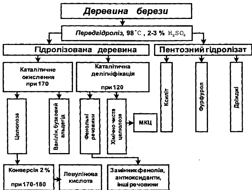
Рис. 2.2 - Схема комплексної переробки деревини берези
