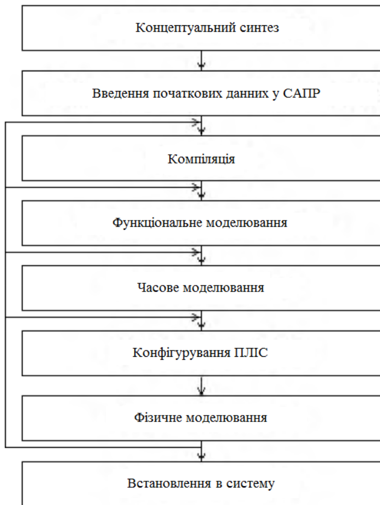
Рисунок 5.12 – Алгоритм автоматизованого проектування ПЛІС
