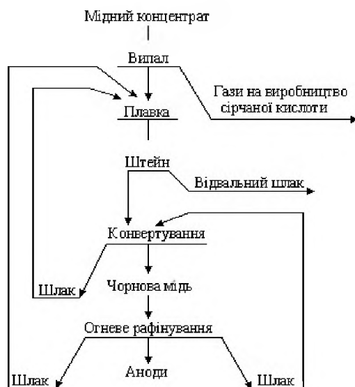
Рисунок 13.6 – Принципова схема переробки платиновмісного мідного концентрату
