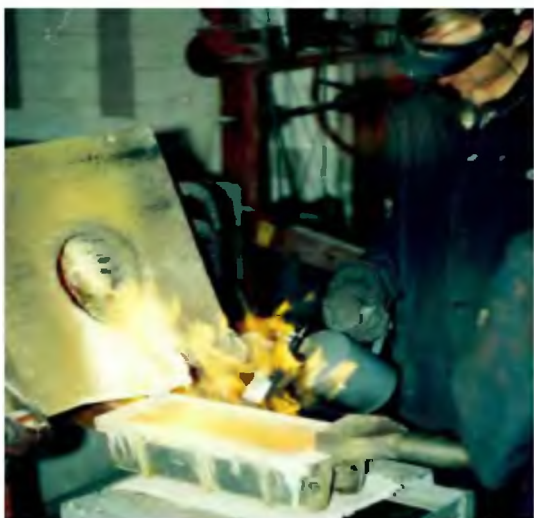
Рисунок 14.11 – Розливання срібла в злитки з печі ІСТ-0,05, частота живлення печі 3 кГц
