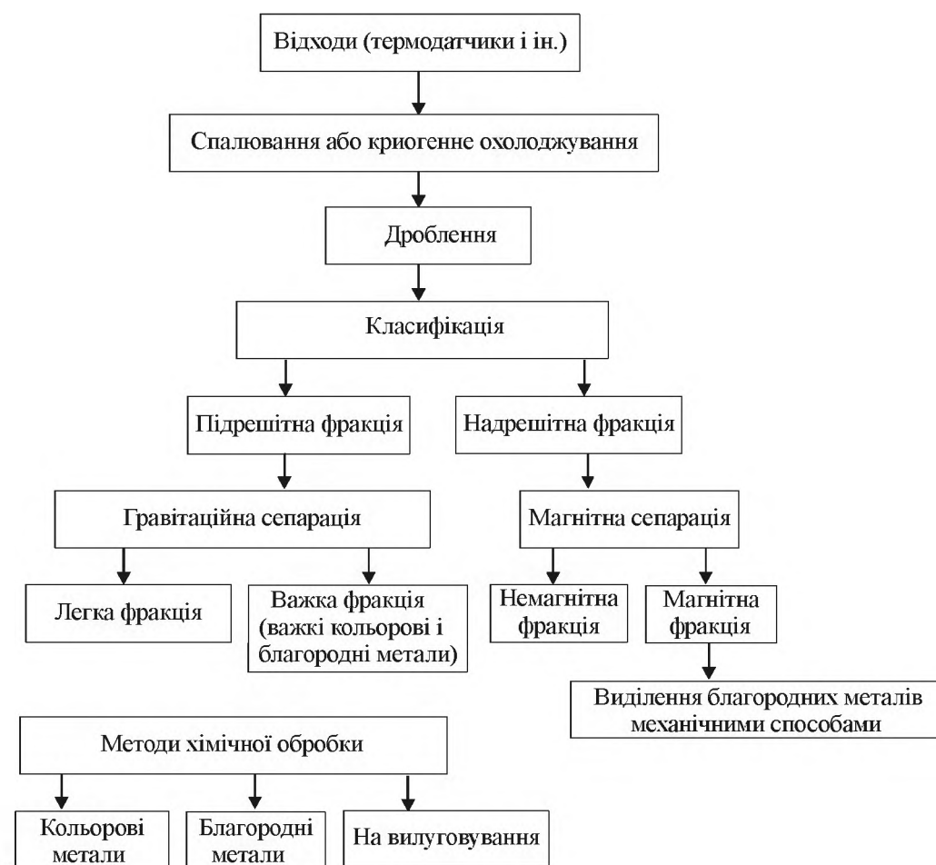
Рисунок 14.51 – Технологічна схема переробки відходів з криогенним охолодженням і хімічною обробкою
