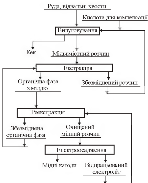
Рисунок 1.23 – Спрощена схема одержання міді за технологією «вилуговування–екстракція–електроліз»
