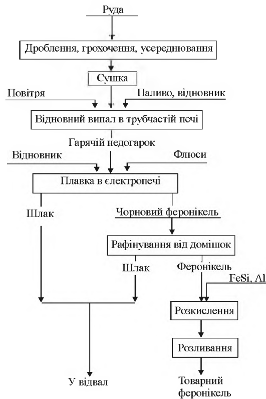
Рисунок 2.18 – Принципова технологічна схема виробництва феронікелю за способом «ЕЛКЕМ»
