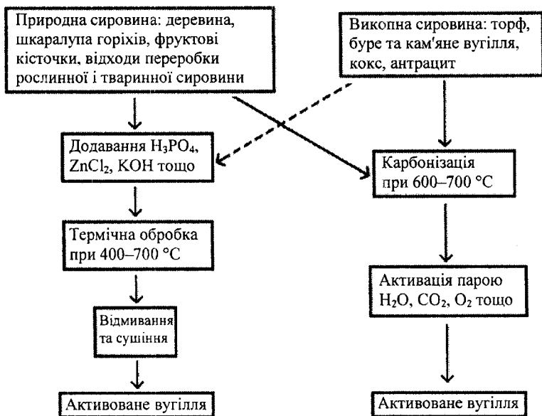
Рис. 2.8. Загальна схема одержання активованого вугілля
