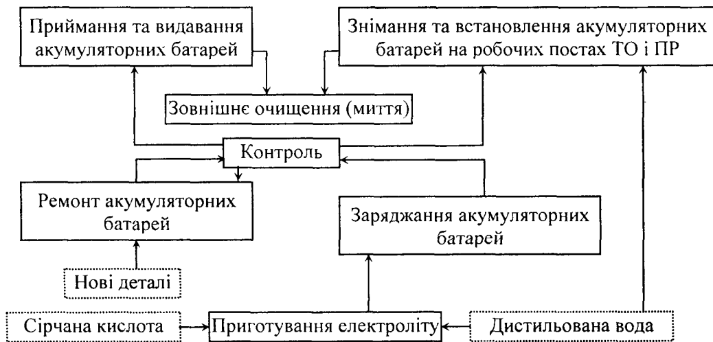
Рис. 5.22. Схема технологічного процесу відновлення працездатності акумуляторних батарей
