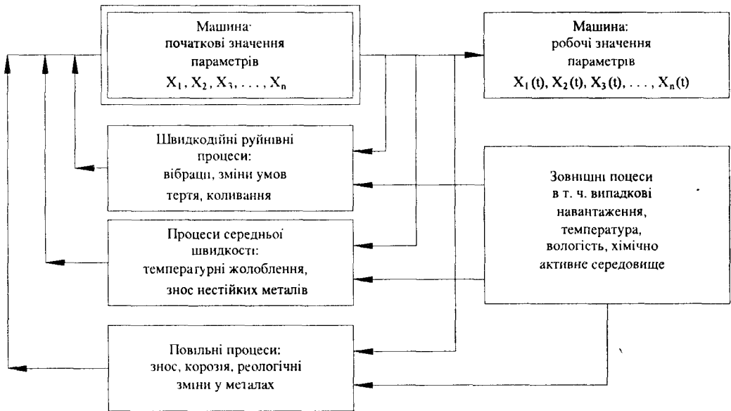
Рис. 1.5. Взаємозв'язок між внутрішніми процесами в АТЗ під час дії на них зовнішніх чинників
