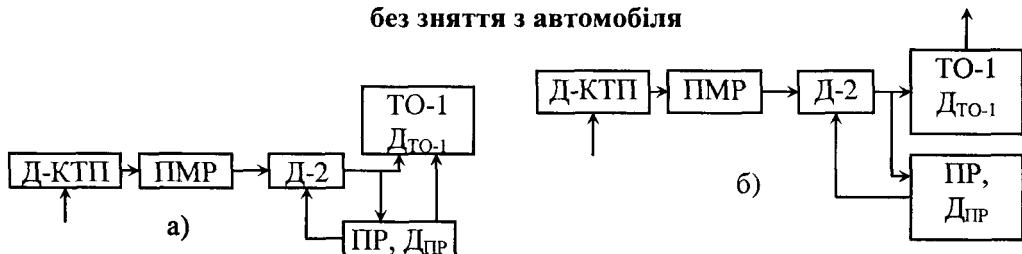
Рис. 6.5. Схеми технологічних процесів із застосуванням діагностування для АТП з автомобілями малої вантажності або таксомоторами: а) технологічний процес ТО-1; б) технологічний процес ТО-2
