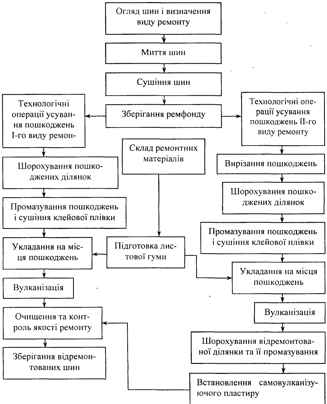
Рис. 5.38. Схема технологічного процесу ремонту шин
