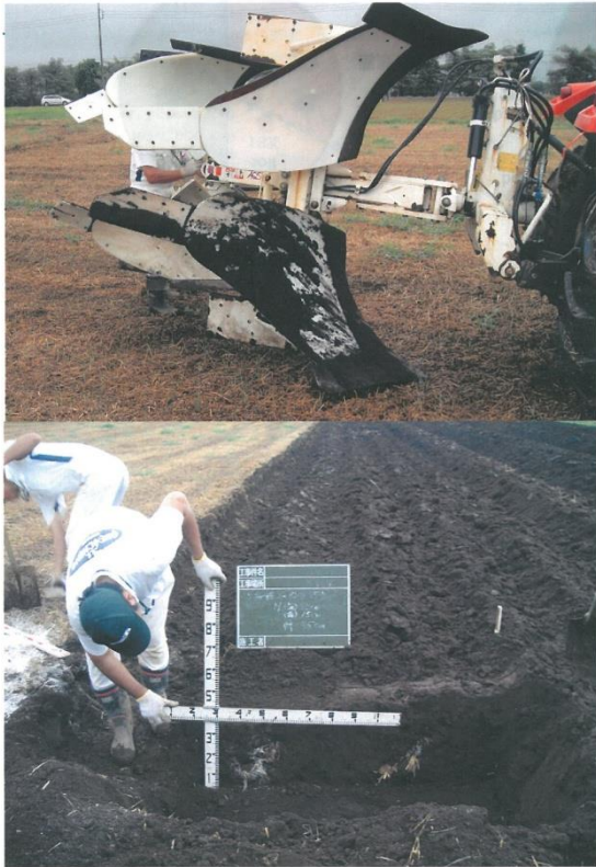
Рис. 11.1. Глибока оранка плантажним плугом з обертанням скиби (Японія, 2011 р.).
