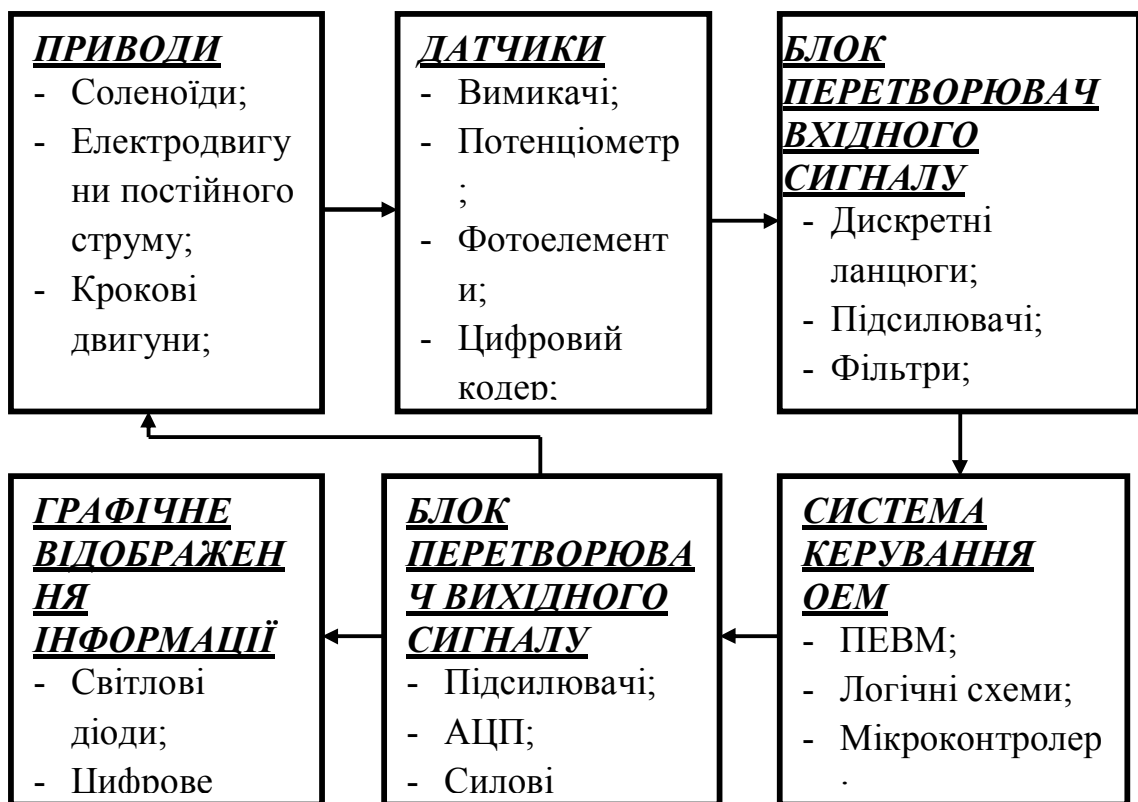
Рис. 2.2. Ієрархічна структура мехатронної системи
