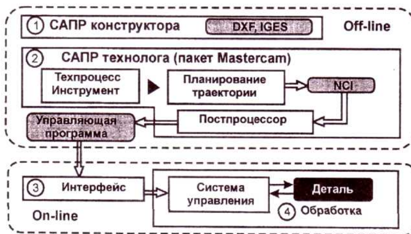
Рис. 9.2. Блок-схема комплексу програмування рухів
