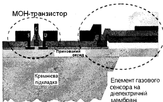
Рис. 1.18. Структури КНІ КМОН-інвертора і його паразитні ємності (а); монолітно інтегрованого транзисторного і чутливого газового елементів (б)
