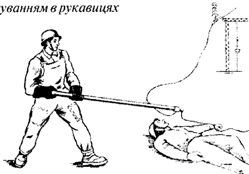
Рис. 13.2. Звільнення потерпілого від дії струму в електроустановках напругою понад 1000 В ізольовуючою штангою
