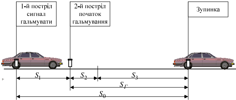
Рис. 2.10. Схема визначення складових елементів гальмового шляху автомобіля
