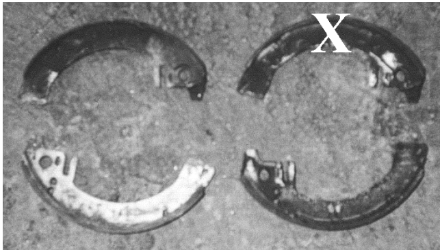
Рис. 4.2. Колодки гальмових механізмів передніх коліс автомобіля
