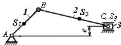
Рис. 2.3. Кінематична схема кривошипно-повзунного механізму
