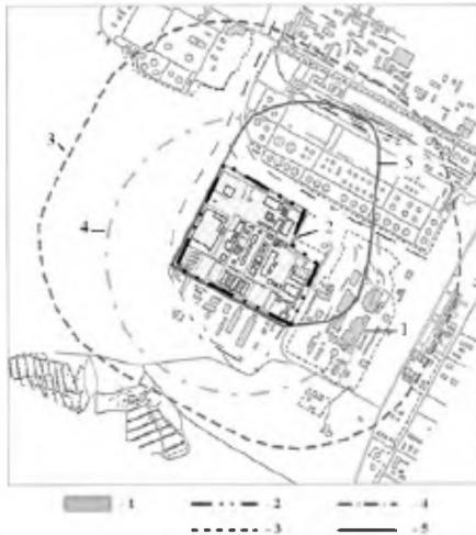
Рис. 3.9. Схема планування СЗЗ в умовах реконструкції міста і промислових підприємств
