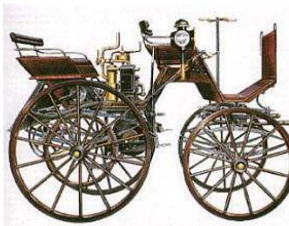
Автомобіль Даймлера. Двигун об'ємом 469 куб.см, потужністю 1.5 л.с. при 700 об. в хв., швидкість 16 км в год.
