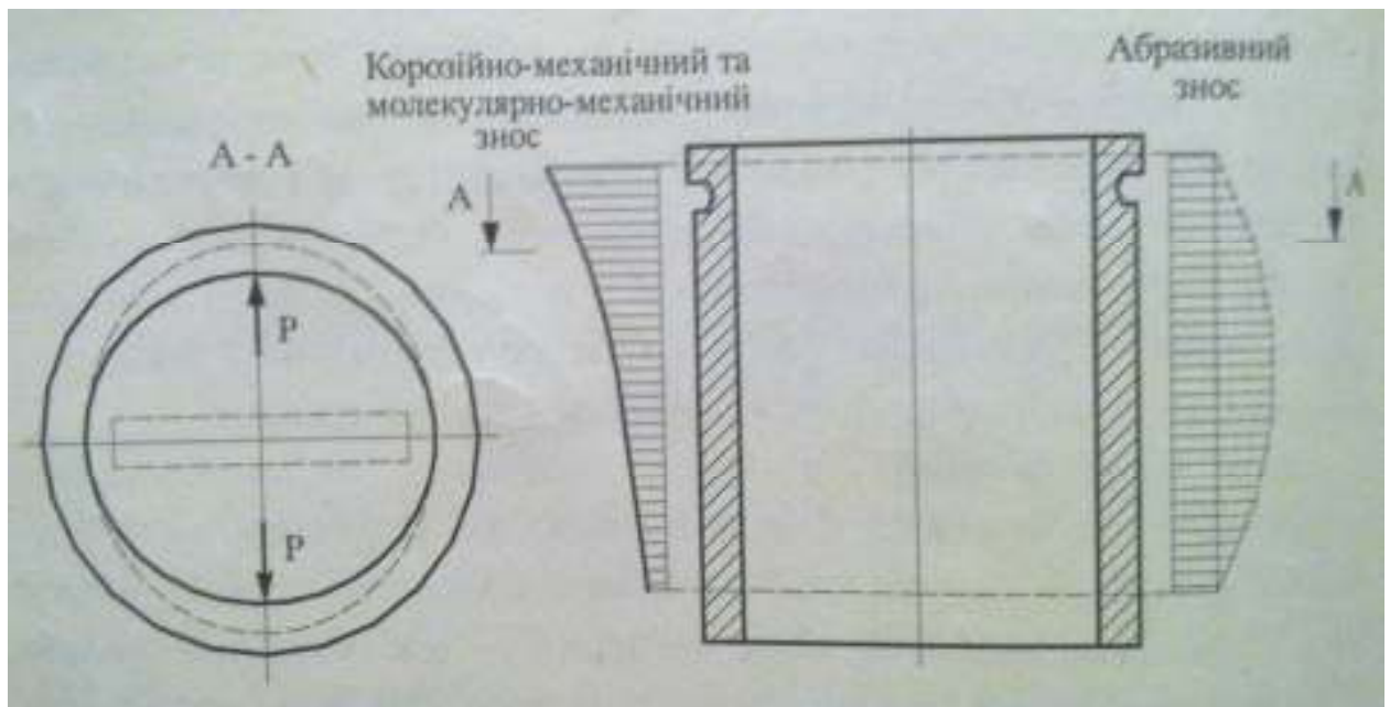
Рис. 1.3 Характерні зношення дзеркала циліндрів двигуна
