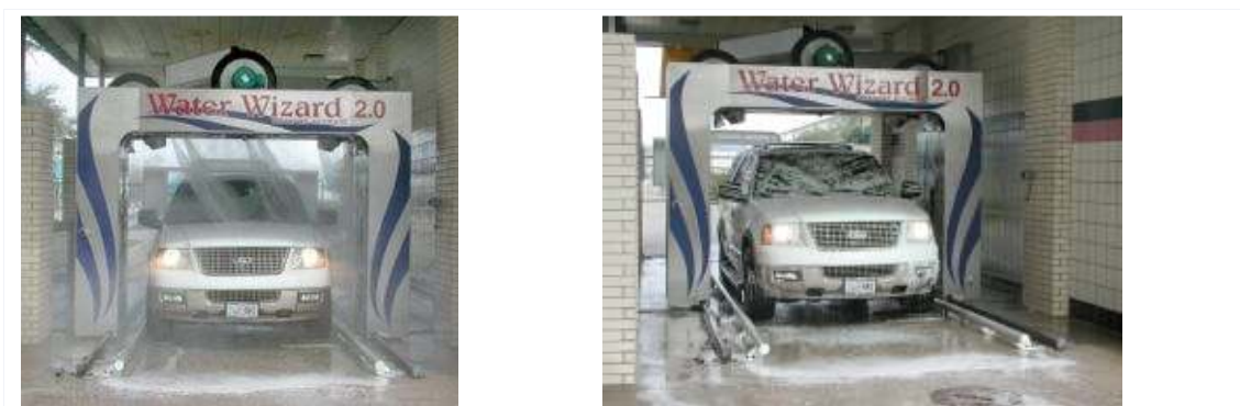
Рис. 3.7. Щіткові мийні установки порталного типу
