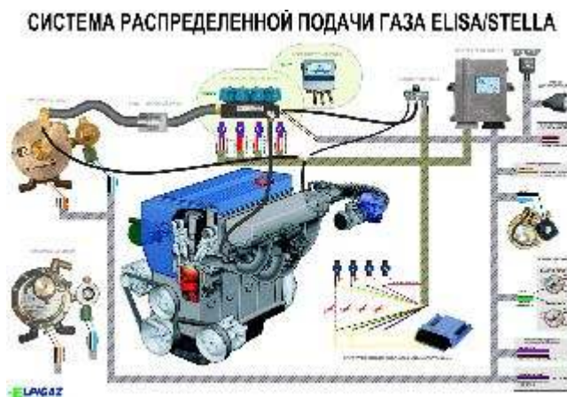
Рис 6.1. Система ГБО 4-го покоління (розподіленого уприскування газу)
