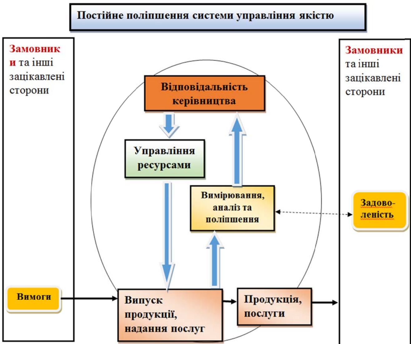
Рис. 7.16. Модель системи управління якістю, що базується на процесному підході (суцільна стрілка зображає види діяльності, а штрихова – інформаційні потоки)
