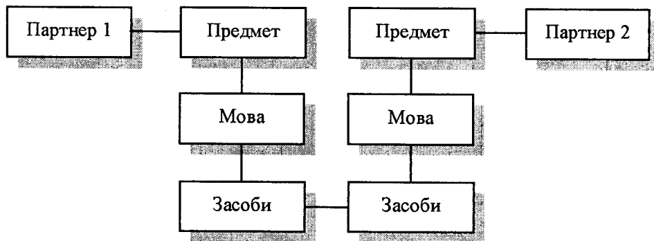
Рис. 5.1. Подання обміну інформації у вигляді трирівневої моделі
