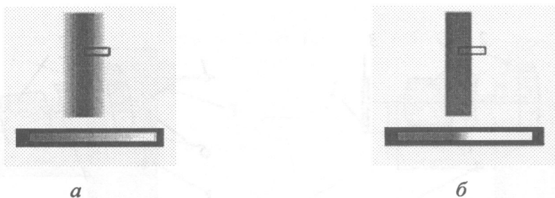
Рис. 3.63. Контрастність сусідніх ділянок кадру: a – якщо кадр не у фокусі; б – якщо кадр у фокусі
