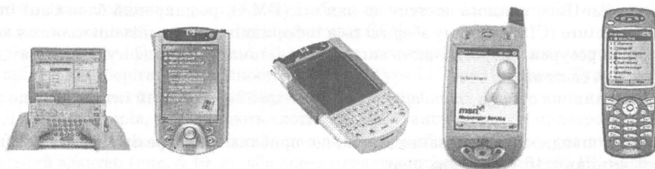
Рис. 4.9. Ручні і кишенькові комп'ютери: а – ручний комп'ютер; б – кишеньковий комп'ютер без клавіатури; в – кишеньковий комп'ютер із клавіатурою; г – кишеньковий комп'ютер з убудованим телефоном; д – «інтелектуальний» телефон
