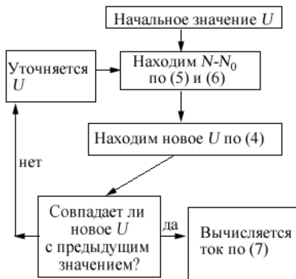
Рис. 7. Самосогласованная процедура вычисления потенциала проводника U и тока в точечной модели проводника.
