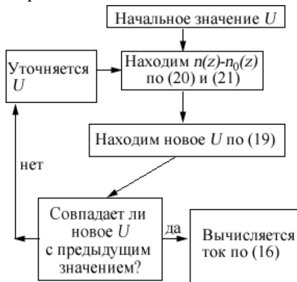
Рис. 16. Самосогласованная процедура вычисления потенциала проводника U и тока в расширенной модели проводника.
