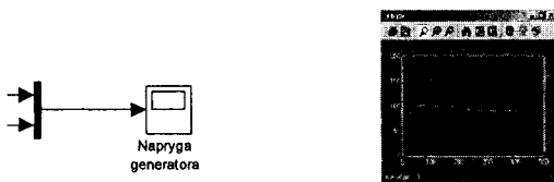
Рисунок 4.1 – Блок Scope (декілька сигналів)
