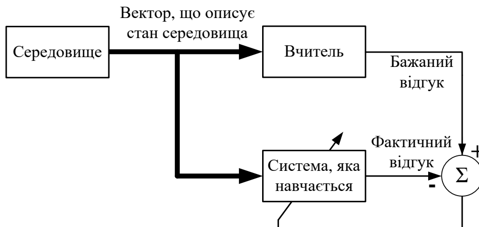
Рис. 10.6 Схема реалізації навчання „з вчителем”
