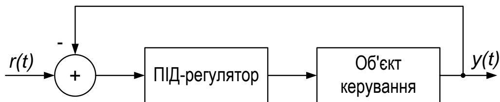
Рис. 7.2. Структура системи із застосуванням ПІД-регулятора
