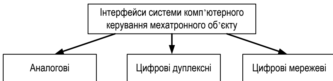
Рис. 5.9 Типи інтерфейсів системи комп'ютерного керування мехатронного об'єкта
