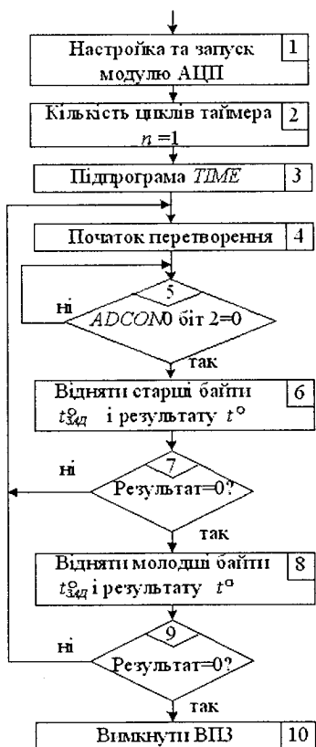
Рис. 20.22. Блок-схема АЦП та вимірювання температури
