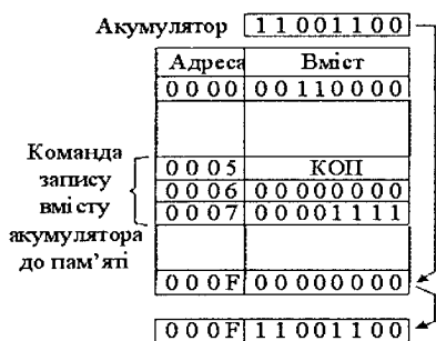
Рис. 20.7. Принцип реалізації команди з прямою адресацією
