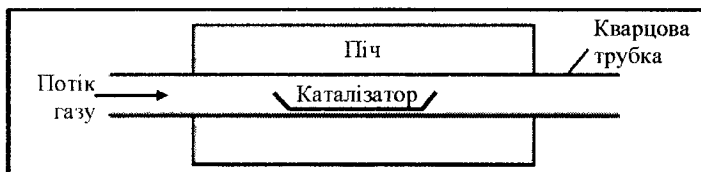
Рис. 5.25. Схема установки для одержання нанотрубок методом хімічного осадження
