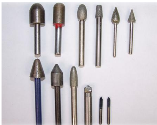
Рисунок 1.6 – Фрези з багатошаровим алмазним наконечником і напиленням
