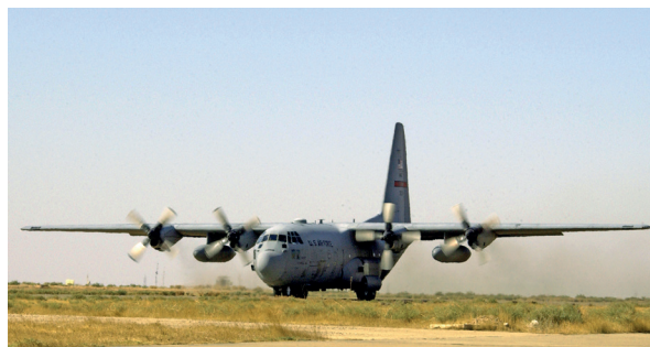
Рис. 13.7. C-130 Hercules. C-130 Геркулес є універсальним літаком для аеромедичної евакуації. Він може перевозити до 70 нош з пораненими і здійснювати польоти в найсуворіших умовах.
