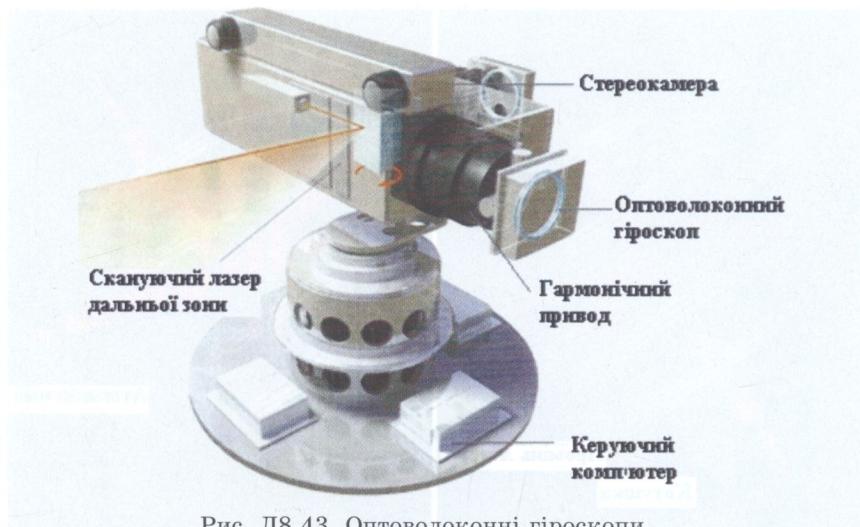
Рис. Д8.43. Оптоволоконні гіроскопи, вбудовані в систему навігації мобільного робота
