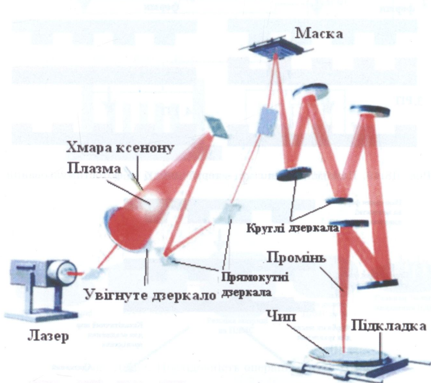
Рис. Д8.48. Система проектування із дзеркалами (діапазон жорсткого УФ)
