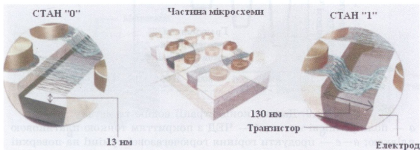
Рис. Д8.12. Провисаючі та розпрямлені нанотрубки представляють стани «1» та «0» ланок оперативної пам'яті нового типу
