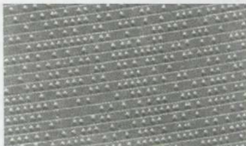
Рис. 1.50. Моделювання запису інформації за допомогою атомів кремнію на золотих доріжках. Комірки для розташування атомів кремнію на золоті становлять область із 20 атомів кремнію під доріжкою.
