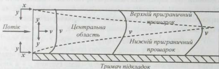
Рис. 1.19. Схематичний переріз розподілу швидкості руху газового потоку як функції поперечної координати у за різних фіксованих значень повздовжньої координати x та утворення приграничних квазінерухомих прошарків у циліндричному реакторі
