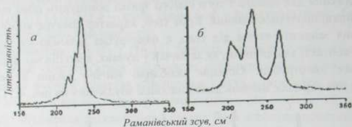
Рис. 4.112. Порівняння спектрів радіальних дихальних мод вуглецевих нанотрубок при збудженні випромінюванням 785 нм зразків: а – індивідуалізованих вуглецевих нанотрубок; б – вуглецевих нанотрубок у пучку. (Згідно з O'Connell M.J. et al. Phys. Rev. B 69 (2004) 235415)
