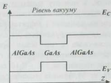
Рис. 2.49. Схема утворення квантової ями з двох гетеропереходів GaAs/Al_xGa_{1-x}As
