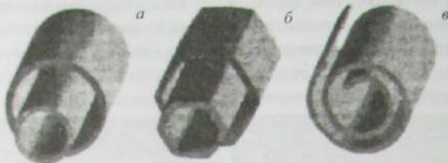
Рис. 4.61. Моделі поперечних структур багат шарових нанотрубок: а – “російська матрьошка”; б – шестигранна призма; в – сувої
