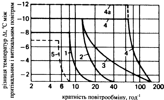
Рис. 8.20. Вибір повітророзподільників залежно від годинного повітрообміну і різниці температур притікального і витікального повітря (температуру витікального повітря міряли у передбаченому для витікання внутрішнього повітря отворі світильника [11]): 1 – тангенційні повітророзподільники, стельові і настінні; 2 – ежекційні (дифузійні) повітророзподільники стельові і настінні; 3 – стельові завихрювальні повітророзподільники; 4 – підлогові завихрювальні повітророзподільники; 4а – якомога вище в приміщеннях зі значними тепло- і вологовиділеннями; 5 – джерельні повітророзподільники
