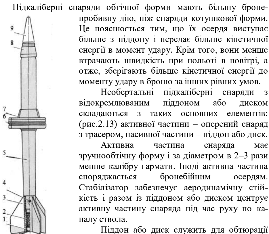
Рисунок 2.13 - Броньбійний підкаліберний снаряд БМ2:
