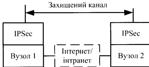
Рис. 6.24. Захищений канал між вузлами
