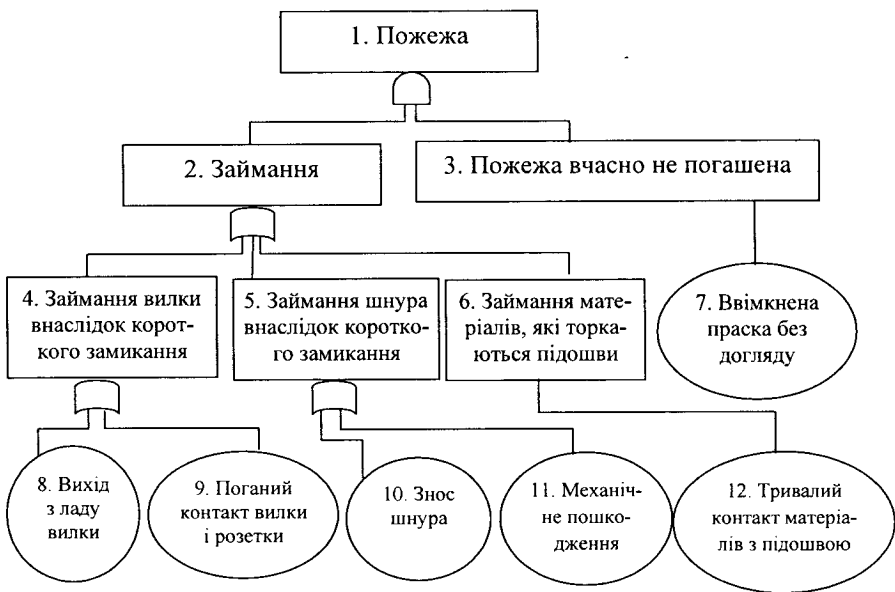
Рисунок 2.2 – Дерево відмов для небезпечної події «пожежа»
