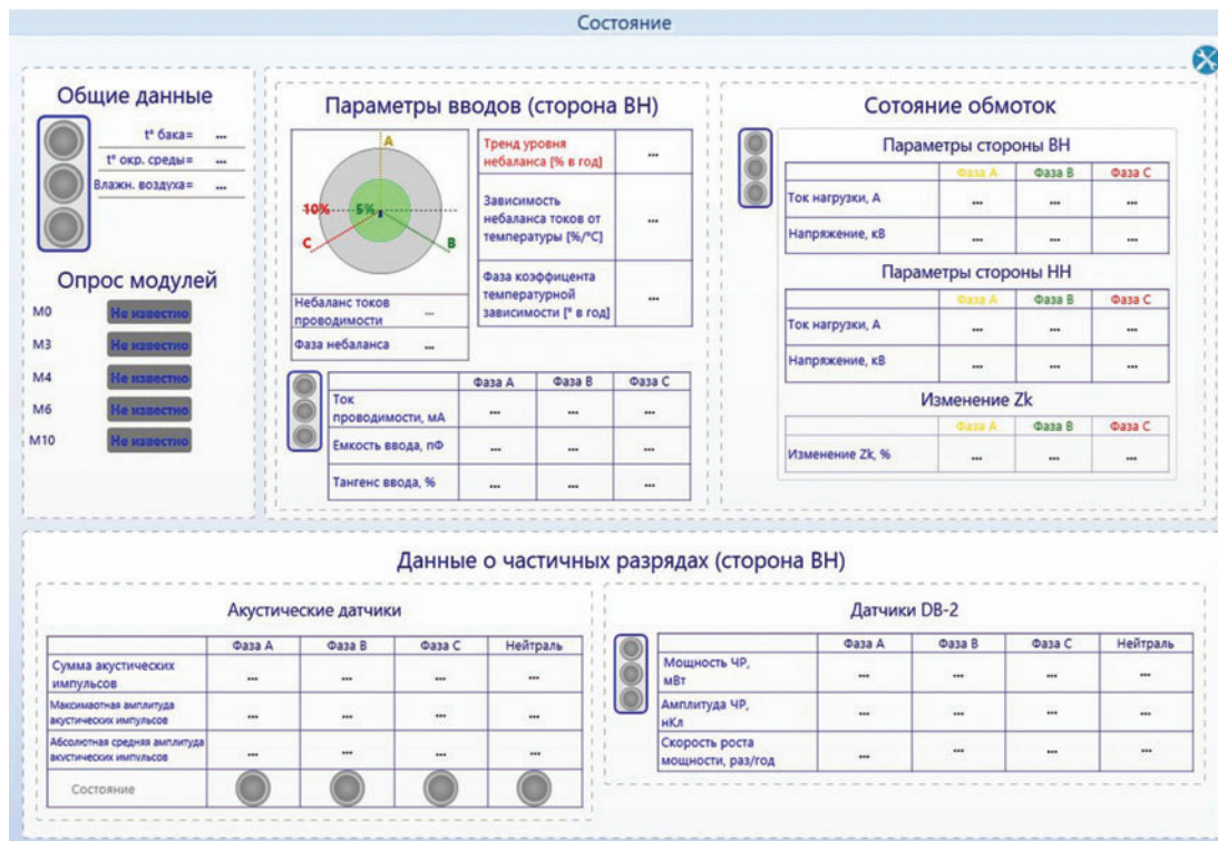
Рис. 4. Вариант интерфейса Пользователя в прикладном программном обеспечении Системы мониторинга вводов
