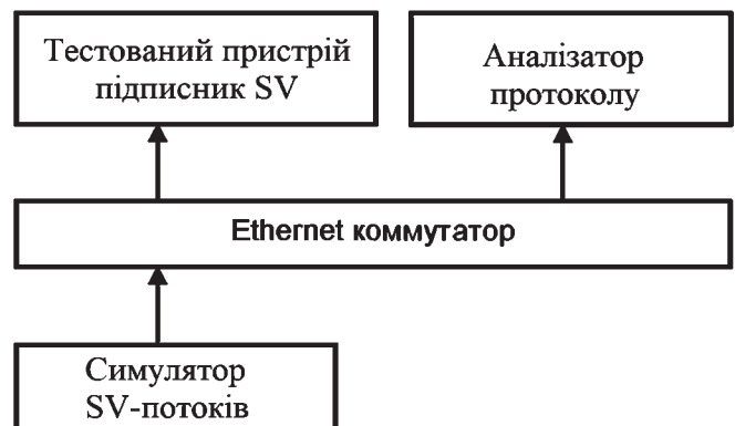
Рис. 5. Архітектура випробувальної системи для перевірки пристрою — підписника вибірових значень
