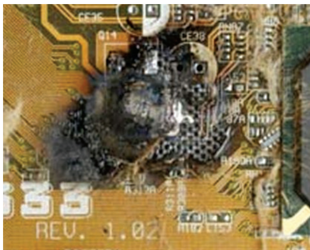
Рис. 2. Конденсатор сгорел от помех 2 –150 кГц
