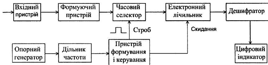
Рисунок 1.5 – Структурна схема ЕРЧ в режимі вимірювання частоти
