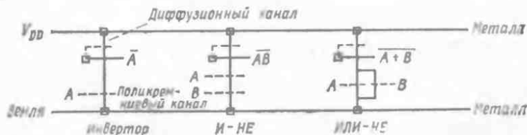
Рис. 4.76. Пример линейечной диаграммы: три диффузионных канала соединяются с двумя металлическими линиями; поликремниевые каналы пересекают диффузионные каналы, что позволяет при поступлении входных сигналов формировать выходные сигналы, представляющие собой значения логических функций входных сигналов.
