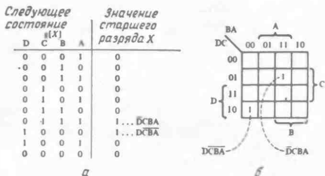
Рис. 4.62. Вывод логического выражения \overline{D}CBA + D\overline{C}B\overline{A} для старшего разряда десятичного счетчика: а — по таблице истинности; б — по карте Карно.
