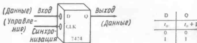
Рис. 1.9. D-триггер и соответствующая таблица истинности.
