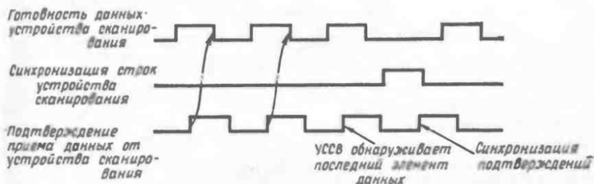
Рис. 8.17. Схема соединения буфера сканирующего устройства и УССВ.
