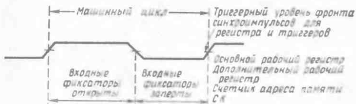
Рис. 2.17. Цикл работы устройства ПЭ 74S481.
