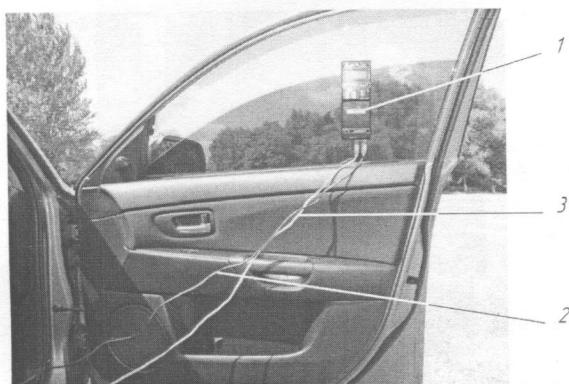
Рисунок 6.2 – Прилад, що закріплений на склі праворуч: 1 – прилад; 2 – дріт, що підключає педометр; 3 – дріт живлення
