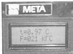
Рисунок 6.8 – Показники t та F , отримані під час вимірювань, відповідно, час спрацювання гальмівної системи та зусилля натискання на гальмівну педаль
