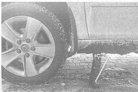
Рисунок 8.9 – Ліве переднє колесо, припідняте за допомогою домкрата
