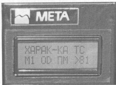
Рисунок 6.5 – Вид напису на індикаторі після вибору режиму тестування
