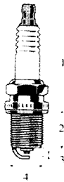
Рисунок 3.1 – Основні параметри свічок запалювання: 1 – шестигранник (розмір під ключ); 2 – довжина різьбової частини; 3 – іскровий проміжок; 4 – діаметр різьбової частини
