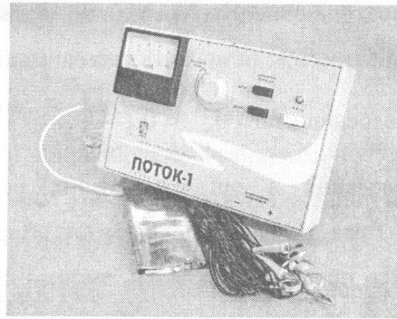
Рис. 4.17. Апарат для гальванізації “Поток-1”.
