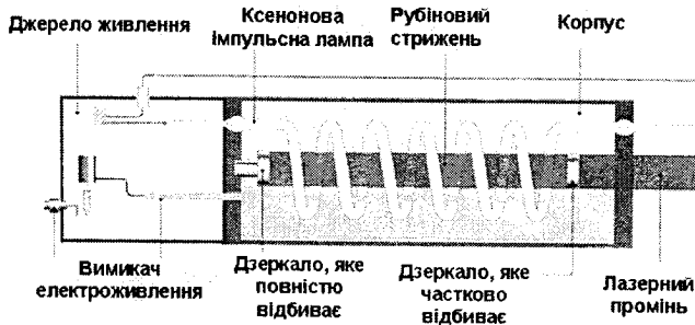
Рис 6.8 Схема будови лазера на рубіні.
