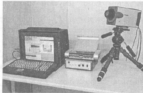
Рис. 5.42. Складові частини тепловізора.
