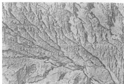
Рисунок 8.2 – Мікрофото елементів будови поверхні зломів: a – ділянка втомних рівчаків на фасетці відколу; б – сходинки відколу, в – міжзеренне руйнування відколу, г – внутрішньозеренне в'язке руйнування відколу, д – рівчаковий візерунок, e – язички
