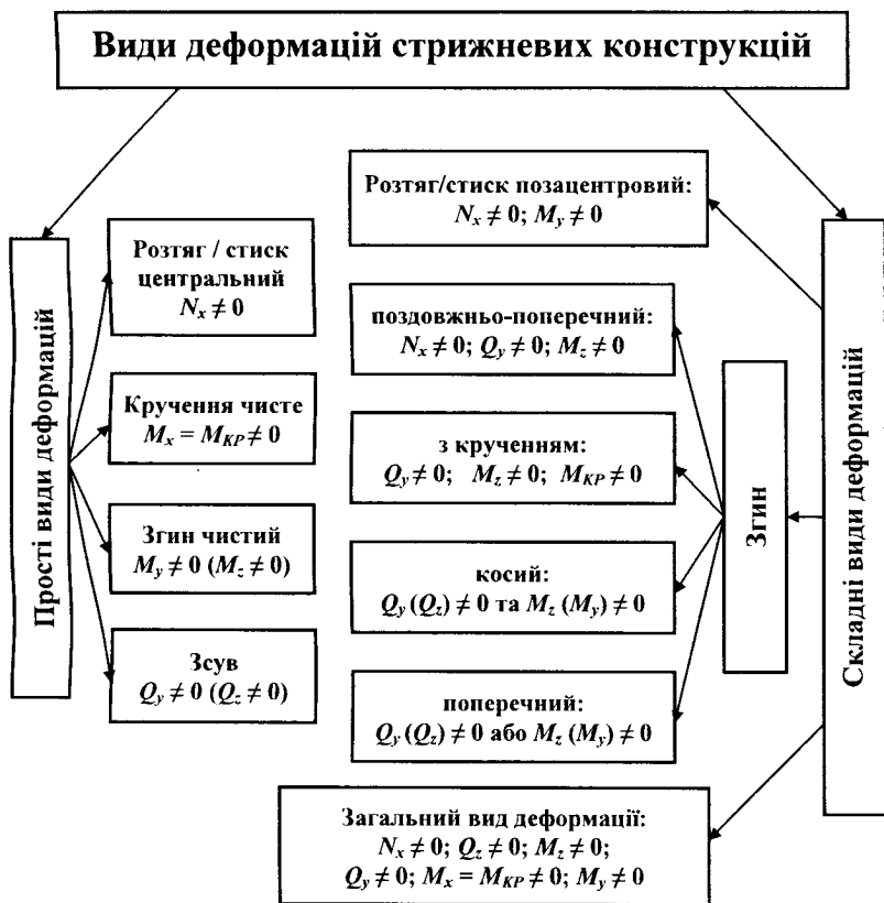
Рисунок 1.1 – Види деформацій стрижневих конструкцій
