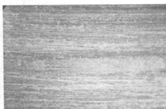
Рисунок 4.9 – Загальний вигляд поверхонь пари тертя зразків (а) та контртіла (б) після зношування в умовах сухого тертя
