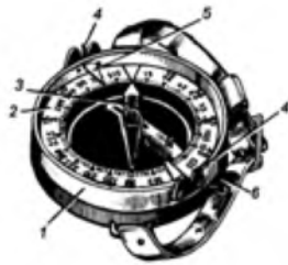
Рис. 2.1. Компас Адріанова: 1 - корпус; 2 - шкала (лімба); 3 - магнітна стрілка; 4 - візирний пристрій (мушка і цілик); 5 - покажчик відліків; 6 - гальмо
