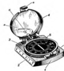
Рис. 2.2. Артилерійський компас (АК): 1 - корпус компаса; 2 - корпус лімба; 3 - кутомірна шкала (лімба); 4 - кришка з дзеркальцем (а); вирізом (б) для візування; защипкою (в); 5 - магнітна стрілка; 6 - виступ гальма стрілки.
