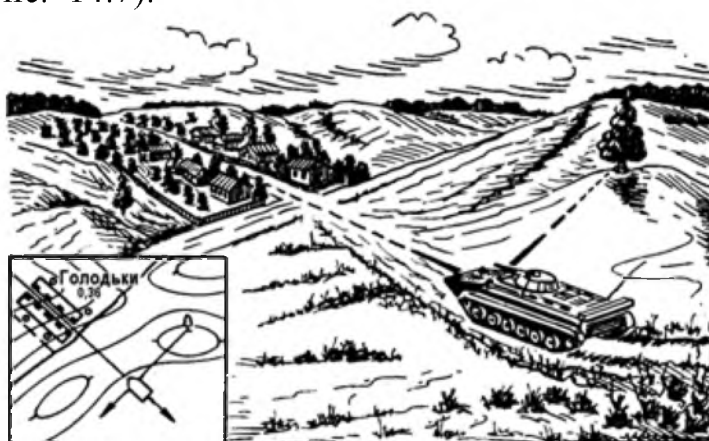
Рис. 14.7. Визначення точки стояння за створом і боковим орієнтиром
