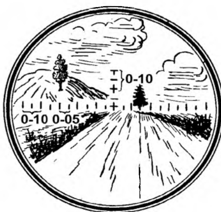
Рис. 2.7. Визначення кутів за допомогою бінокля
